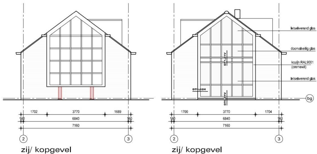
Nr. 08 Bestaande situatie (links) en eerste ontwerp voor de gevelwijziging (rechts) Gebou Architecten
